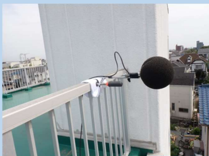
取付方法：手摺りに直接固定
